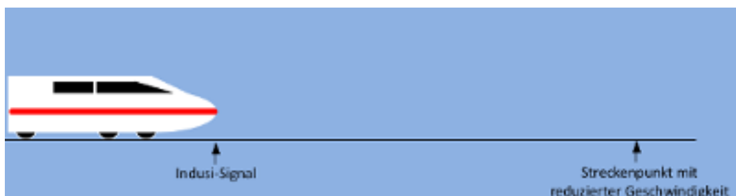
Abbildung 5.1: Schematische Darstellung des automatischen Bremsverhaltens bei einer punktförmigen Zugbeeinflussung (aus: [Nie13])
