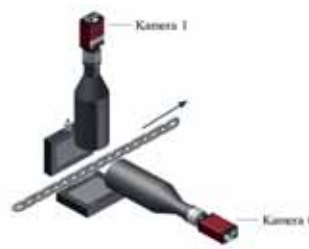
Messung von Gliederketten mit zwei televischen Bildaufnahmekanälen
